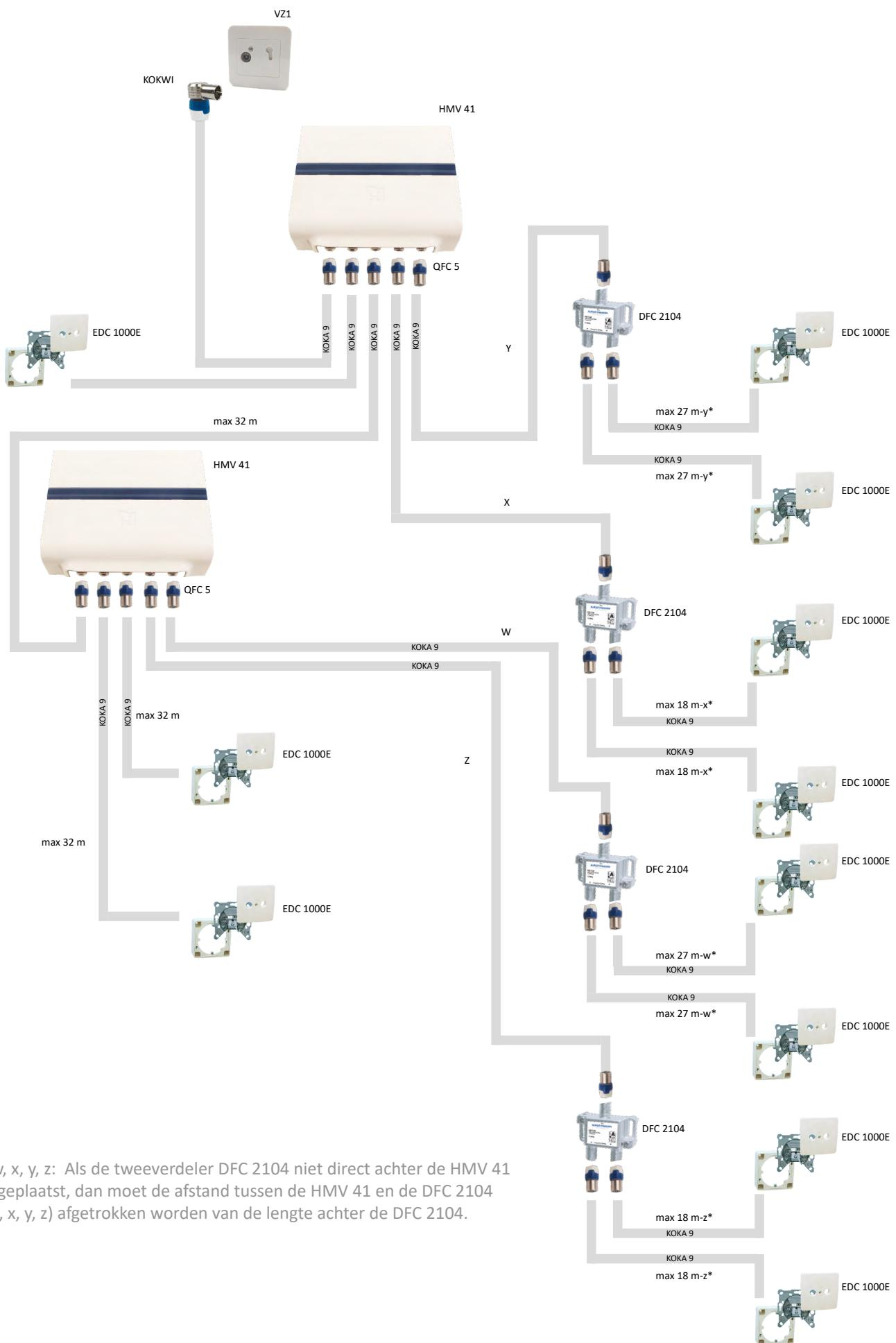
\*w, x, y, z: Als de tweeverdeler DFC 2104 niet direct achter de HMV 41 is geplaatst, dan moet de afstand tussen de HMV 41 en de DFC 2104 (w, x, y, z) afgetrokken worden van de lengte achter de DFC 2104.
